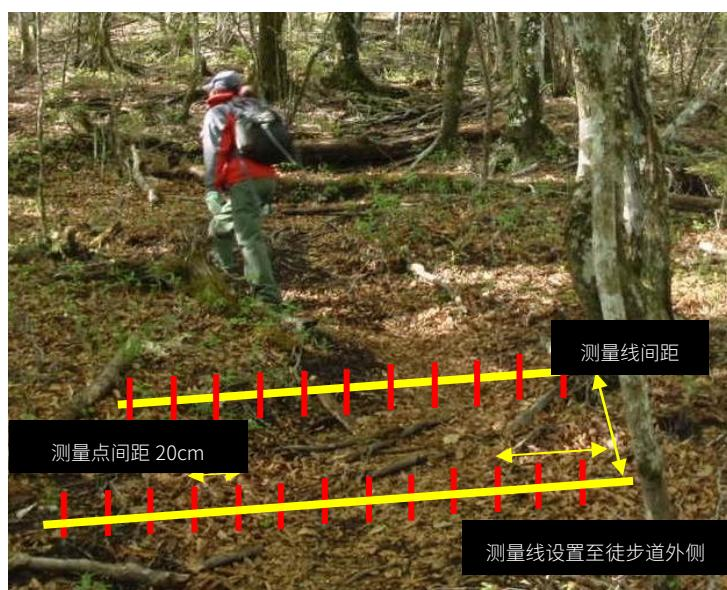
图 22 测量线·测量点设置示例
